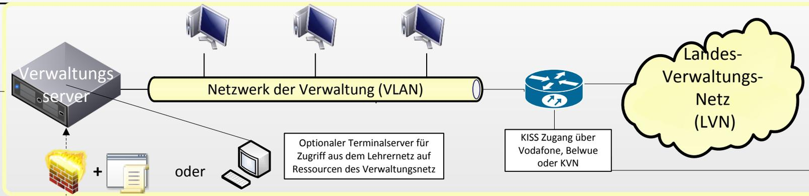
Geregelter Zugriff auf ausgewählte Ressourcen des Verwaltungsnetz (nur eine Richtung): Umsetzbar z.B. über Terminalserver oder Gruppenrichtlinien jeweils in Verbindung mit Firewall.
