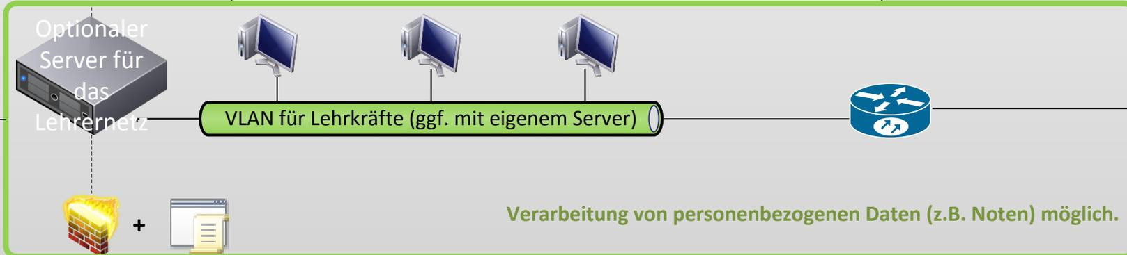
Geregelte Übergabe von bestimmten Daten wie Unterrichtsmaterialien möglich (nur eine Richtung): Umsetzbar über Gruppenrichtlinien in Verbindung mit Firewall.
